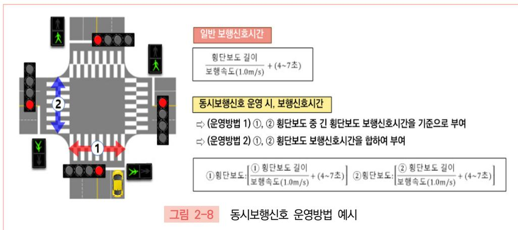
[그림 2-8]과 같이 ①, ② 횡단보도 중 긴 횡단보도 보행신호시간을 기준으로 부여할 경우 ② 횡단보도 보행신호시간은 일반 보행신호시간보다 시간이 추가로 부여되어 보행자의 안전 확보 및 편의를 제공할 수 있으나 대각선 횡단보도와 같이 대각선 방향의 지점으로 이동 (2개의 횡단보도를 횡단)할 수는 없다.
